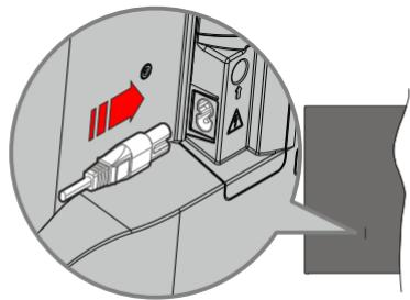
Enchufe un extremo (la clavija de dos orificios) del cable de alimentación desmontable suministrado en la entrada del cable de alimentación situada en la parte trasera del televisor, como se muestra arriba. A continuación enchufe el otro extremo del cable en la toma de corriente de la pared. TV se encenderá automáticamente.
