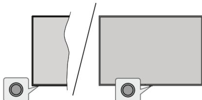
Le bouton de commande vous permet de contrôler les fonctions de Mise en Veille Rapide du téléviseur.
