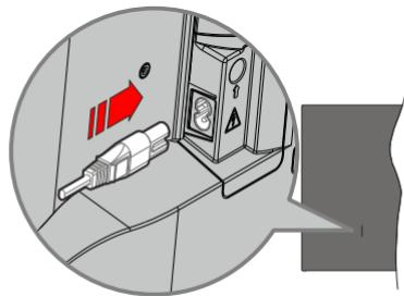
Inserire un'estremità (la spina a due fori) del cavo di alimentazione staccabile in dotazione nell'ingresso del cavo di alimentazione sul lato posteriore del televisore, come mostrato sopra. Quindi inserire l'altra estremità del cavo di alimentazione nella presa di corrente. In questo modo la TV si accenderà automaticamente.
