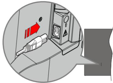
Ligar um das extremidades (ficha de dois polos) do cabo de alimentação amovível fornecido na entrada do cabo de alimentação na parte de trás da TV conforme mostrado acima. Depois ligar a outra extremidade do cabo de alimentação na tomada de corrente eléctrica. A TV ligar-se-á automaticamente..
