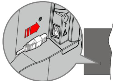
Branchez une extrémité (la fiche à deux trous) du cordon d'alimentation détachable fourni dans l'entrée du cordon d'alimentation située à l'arrière de la TV, comme indiqué ci-dessus. Branchez ensuite l'autre extrémité du cordon d'alimentation dans la prise de courant. Le téléviseur s'allume automatiquement.
